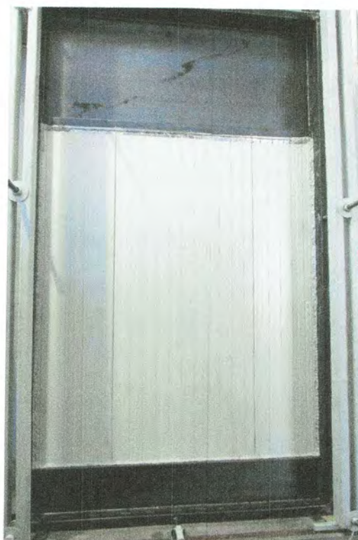
Bild 4 Probekörper auf Prüfstand – Fugen nicht abgeklebt
