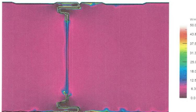
Wärmestromdichte an der Stoßfuge am Beispiel Wand ISOPAR<sup>®</sup>
