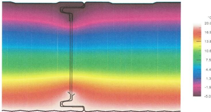
Temperaturverteilung an der Stoßfuge am Beispiel Wand Isopar<sup>®</sup>
